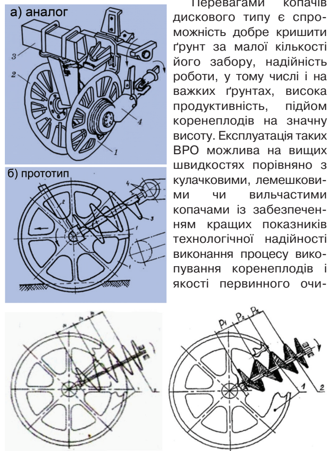
Рис. 1 – Геометричні моделі дискових копачів з прямим шнеком-гелікоїдом в) і похилим г) змінного кроку навивки ( p_1 > p_2 > p_3 )
