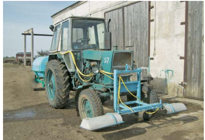
Рис. 3 – Обприскувач для внесення гербіцидів МВГ-300/500 (НВП «Наука», м. Сімферополь)
