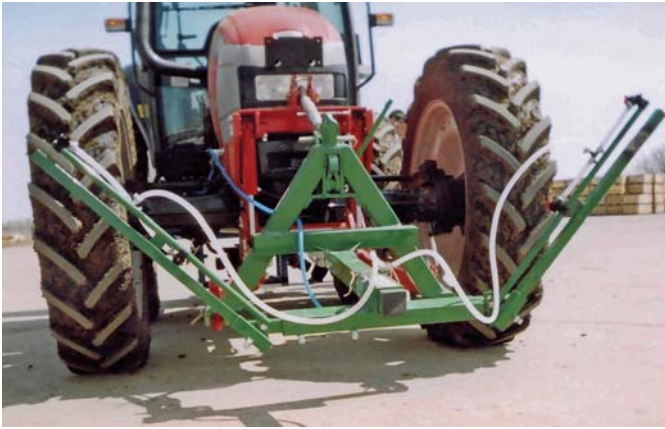
Рис. 9 – Переднє навесне обладнання зі штангами обприскувача для внесення гербіцидів «Eurolux 800 TM» («Lemken», Німеччина)
