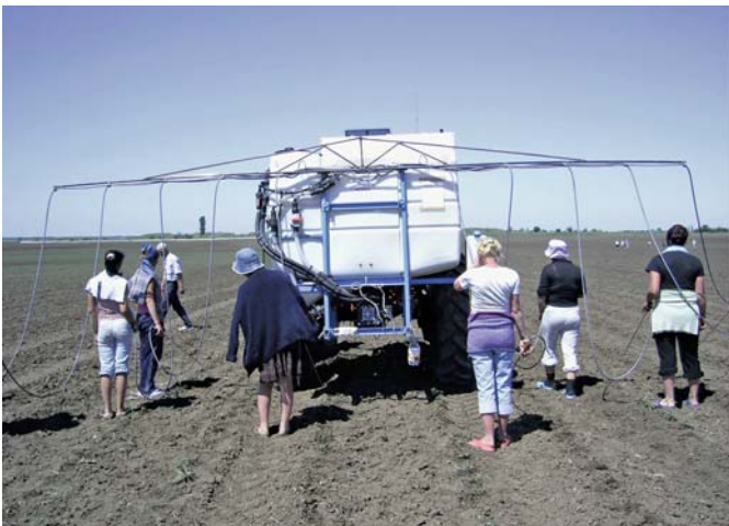
Рис. 10 – Комплектація обприскувача для внесення гербіцидів «Eurolux 800 TM» ручними виносними штангами (на задній навесці трактора)
