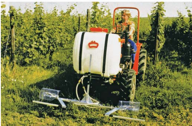
Рис. 6 – Обприскувач для внесення гербіцидів «Herbika 150» («Muller & Sohn Spezialmaschinen GmbH», Німеччина)
