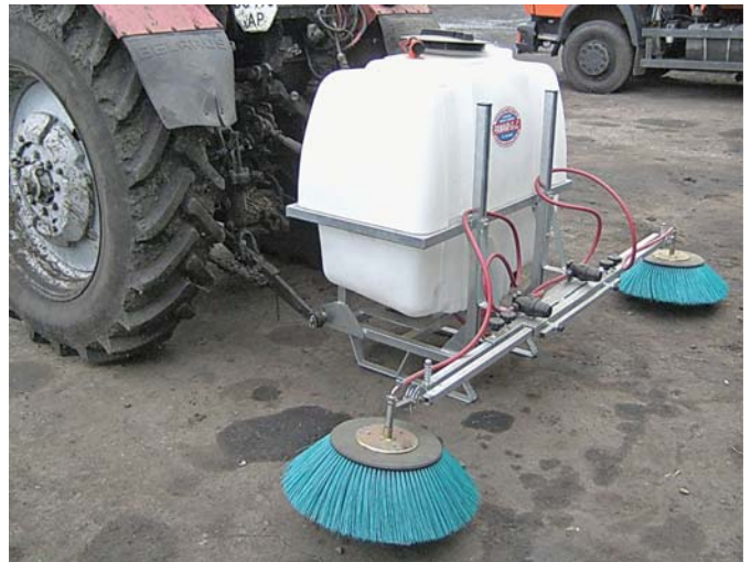
Рис. 7 – Обприскувач для внесення гербіцидів GDE 400 із захисними щітковими барабанами («Off. Mess. Panari Giancarlo & C. s.n.c.», Італія)
