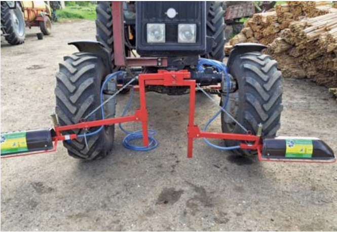
Рис. 5 – Пристосування для внесення гербіцидів «Maximarip» (ПП «Агрореммаш-Спецтехніка», м. Кіровоград)
