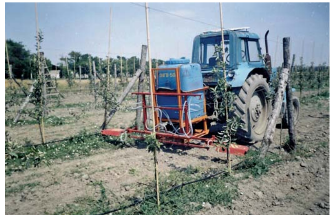
Рис. 4 – Обприскувач для внесення гербіцидів ОНГВ-500 в роботі (НВП «Наука», м. Сімферополь)
