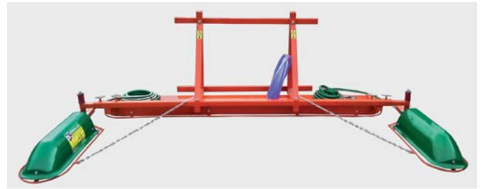
Рис. 2 – Загальний вигляд пристосування для внесення гербіцидів у зібраному вигляді (ПП «Агрореммаш-Спецтехніка», м. Кіровоград)
