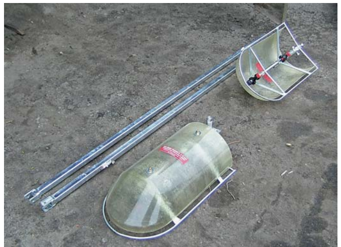
Рис. 8 – Змінні робочі органи обприскувача для внесення гербіцидів GDE 400
