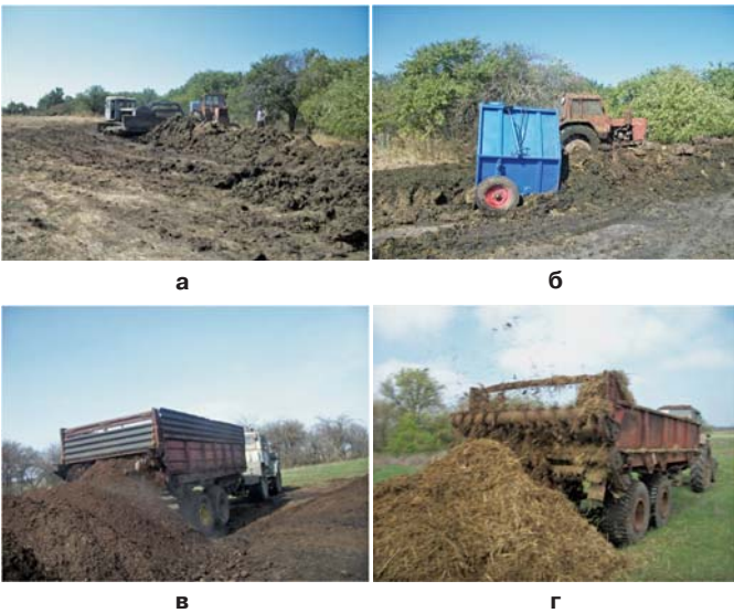
Рис. 4 – Механізовані технологічні операції компостування а – формування бурту бульдозером; б – формування бурту агрегатом у складі трактора МТЗ-80 та аератора-змішувача; в – формування бурту та готування суміші підстилкового посліду гноєрозкидачем ПРТ-10, агрегатованим з трактором Т-150К; г – формування бурту та готування суміші гною в. р. х. агрегатом у складі трактора МТЗ-80 та гноєрозкидача ПРТ-7
