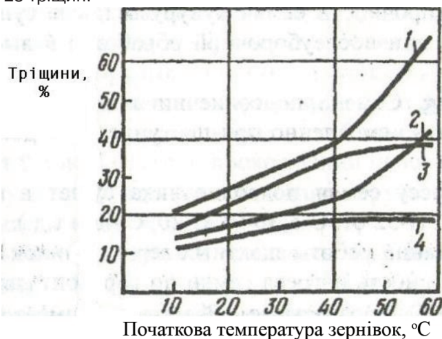
Рис. 2 – Вплив температури на утворення тріщин
