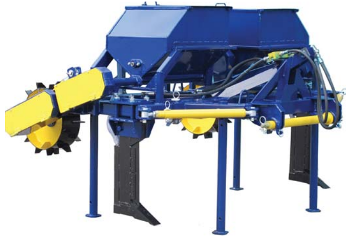
Рис. 3 – Агрегат чизельний садовий АЧС-3,0
