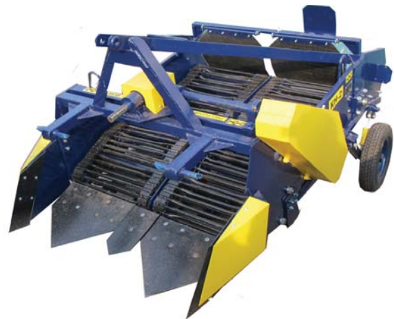
Рис. 4 – Картоплекопалка навісна КН-2-1
