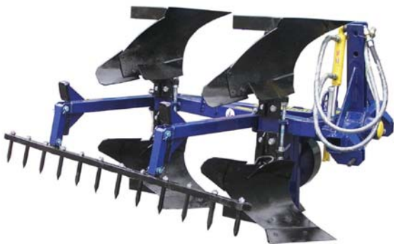
Рис. 2 – Плуг обертовий навісний ПОН-2x25А
