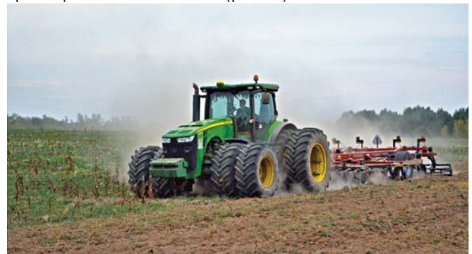
Рис. 1 – Система здвоювання коліс на тракторі John Deere 8310
