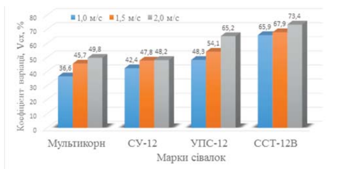
Рис. 1 – Вплив швидкості руху сівалок з нормою висіву насіння 8–10 шт./м на величину коефіцієнта варіації розміщення сходів V_{cx} (фракція дражованого насіння 4,5–5,5 мм)
