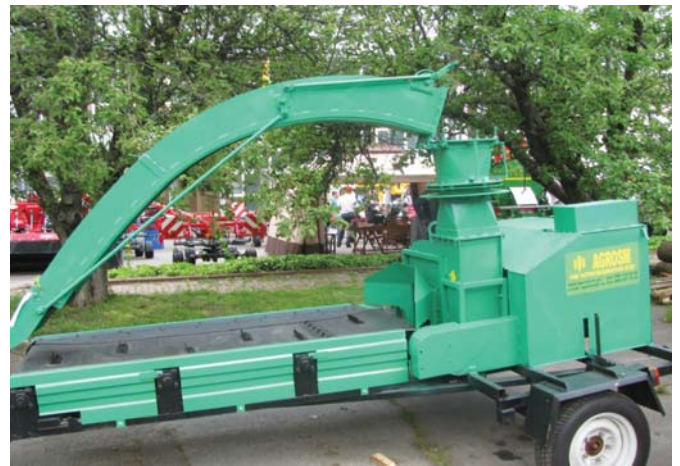
Рис. 32 – Причіпний агрегат для підбору, подрібнення і завантаження в причіп рослинної маси, яка виходить із зернозбирального комбайна
