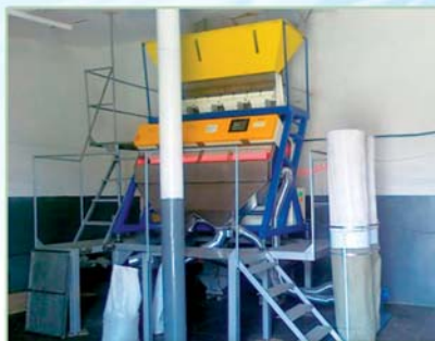
Принцип роботи і інсталяція кольоросортувального обладнання
