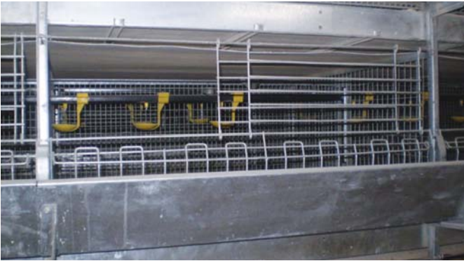
Рис. 44 – Фрагмент комплексу автоматизованого кліткового обладнання для вирощування ремонтного молодняка курей-несучок ОАРМ виробництва ПрАТ «Завод «Ніжинсільмаш»
