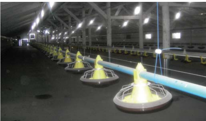
Рис. 45 – Фрагмент обладнання для утримання батьківського поголів'я курей-несучок та обладнання для утримання курчат-бройлерів на підлозі ОПБ-2 виробництва ПрАТ «Завод «Ніжинсільмаш»
