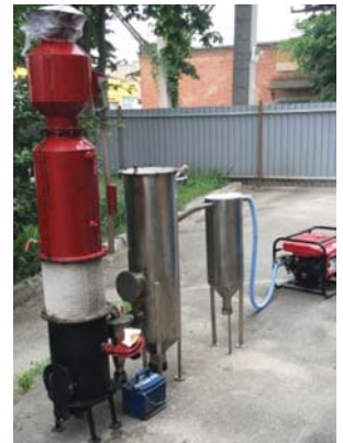
Рис. 51 – Установка газогенератора УГК-20 з під'єднаним електрогенератором
