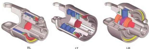
Рис. – 53 Обмежувачі крутного моменту: RL - обгінна муфта; LT – двосторонній кулачковий обмежувач крутного моменту; LR – автоматичний обмежувач крутного моменту.
