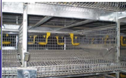
Рис. 43 – Фрагмент кліткової батареї для утримання перепелів ОКП виробництва ПрАТ «Завод «Ніжинсільмаш»
