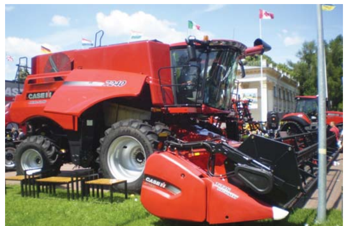
Рис. 29 – Роторний комбайн AXIAL-FLOW-7240 Case-IH зі спареними передніми колесами ходової системи
