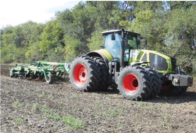
Рис. 1 – Трактор з можливістю роботи на спарених колесах дозволяє раніше вийти в поле з агрегатом
