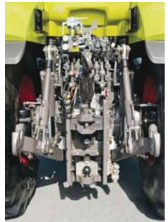
Рис. 2 – Триточкова навіска, тяговий брус, регулюваний по висоті фаркоп, крюк для причепа (пітон-фікс), силова гідравліка, пневматичні гальма причепа трактора
