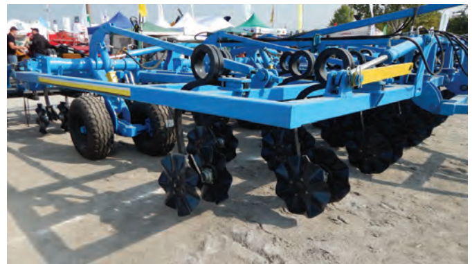
Рис. 25 – На виставці «АгроЕкспо 2017» було представлено новинку компанії «Агромаш-Калина» сучасний дисковий луцильник для вертикального обробки ґрунту JK-6
