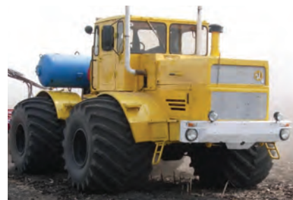
Рис. 3 – Конструкційне рішення для зменшення тиску на ґрунт
