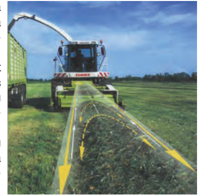
Рис. 3 – Комбайн Jaguar із системою автоматичного водіння CLAAS CAM PILOT
