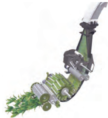
Рис. 4 – Живильно-подрібнювальний апарат кормозбирального комбайна Jaguar фірми Claas
