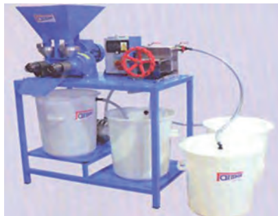
Рис. 36 – Комплект пресувального обладнання Farmer 10/20 фірми «Farmet» (Чехія)
