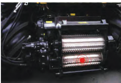
Рис. 6 – Живильний апарат з каменеметалодетектором
