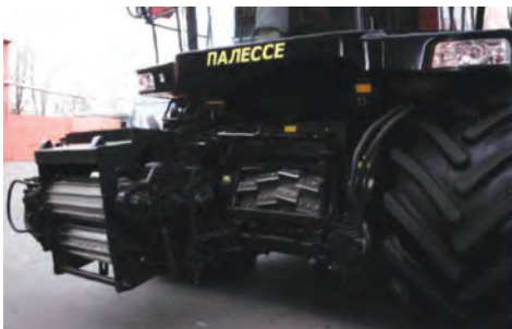
Рис. 5 – Конструкція живильно-подрібнювального апарату
