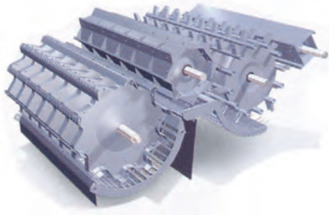
Рис. 2 – Конструкційно-технологічна схема МСС комбайна CSX-7080 в складі (зліва-направо): молотильний барабан, відбійний бітер, ротаційний барабан-соломосепаратор, відбійний бітер
