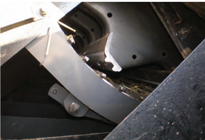
Рис. 3 – Біло молотильного барабана та молотильно-сепарувальна дека (у передній, приймальної частині МСС)
