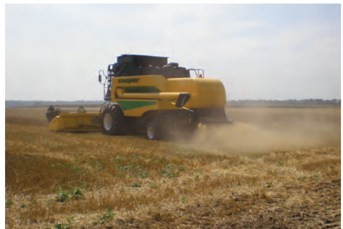
Рис. 8 – Комбайн CSX-7080 подрібнює та розсіває солому і полову по полю
