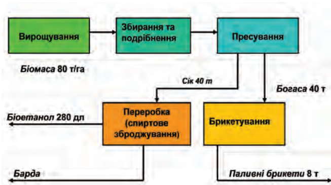
Рис. 2 – Технологічна схема переробки цукрового сорго в біоетанол і паливні брикети
