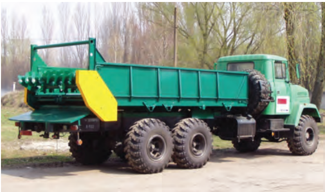
Рис. 1 – Агрегат для внесення твердих органічних добрив АРОД-11 на базі автомобільного шасі КрАЗ-6322
