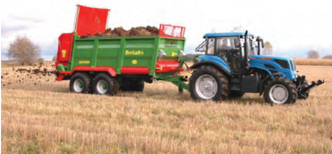
Рис. 2 – Розкидач органічних добрив "Геркулес" фірми "Pronar" в роботі
