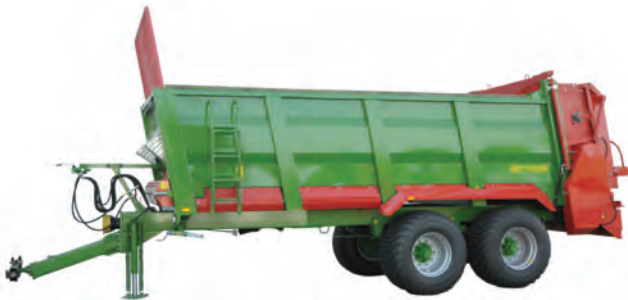
Рис. 1 – Загальний вигляд розкидача органічних добрив "Геркулес" фірми "Pronar" (Польща)
