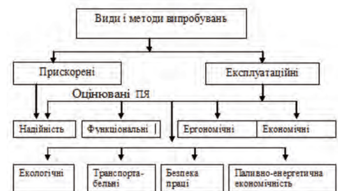
Рис. 3 – Класифікація видів і методів випробувань та оцінюваних показників якості ( ПЯ )
