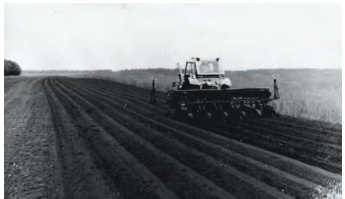
Рис. 5 – Сівалка СО-4,2 під час сівби столової моркви в гребені
