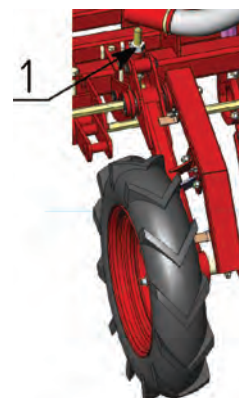
Рис. 17. Опорно-приводне колесо з гвинтовим регулюванням для роботи на рівній поверхні, гребнях і грядках
