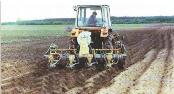
Рис. 7 – Сівалка СМО-2,8 в роботі
