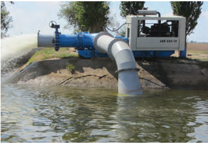
Рис. 5 – Насосна станція СНП 500-10 (ПП «Агроводмаш, м. Херсон»)
