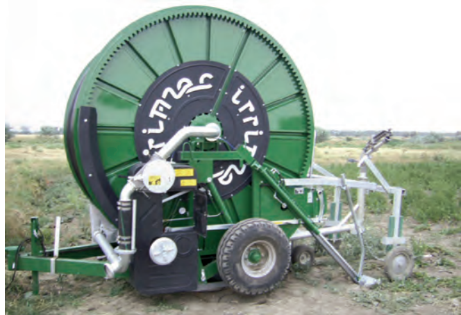
Рис. 7 – Дощувальна машина шланго-барабанного типу «MF 3-110 TG 600» («Irrimes, Італія»)
