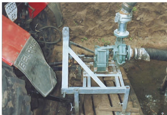
Рис. 4 – Пересувна насосна станція з приводом від ВВП трактора МЕС - D 3/65 («Caseprari S.p.A.», Італія)
