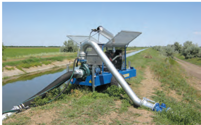
Рис. 2 – Пересувна насосна станція з дизельним приводом «Idrofoglia» («Idrofoglia Srl», Італія)
