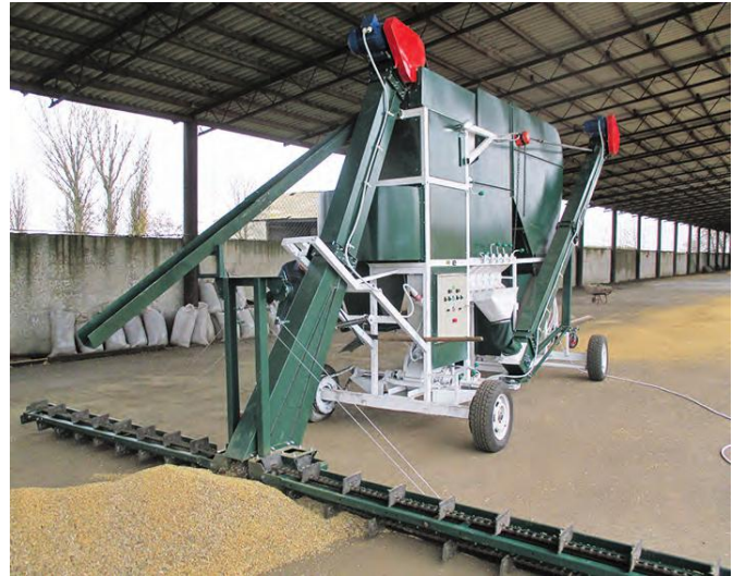
Рис. 16 – Самопересувний очисний комплекс «СОК-25»
