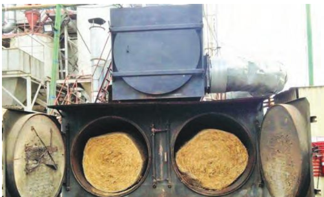
Рис. 36 – Теплогенератор ТГТ виробництва заводу «Сокол»
