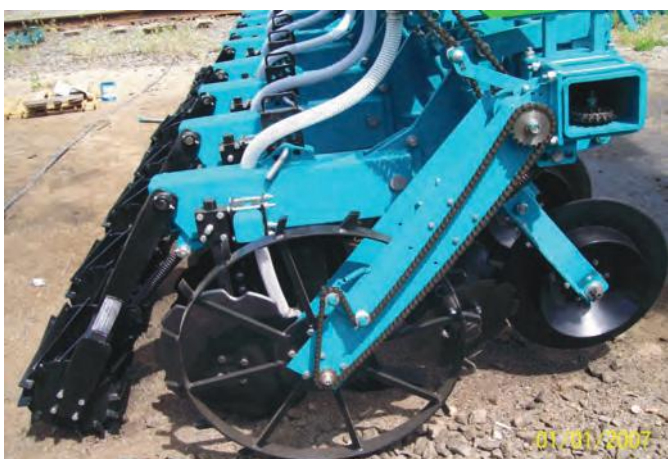
Рис. 2 – Робочі органи до агрегата АСОГ для смугового обробітку ґрунту
