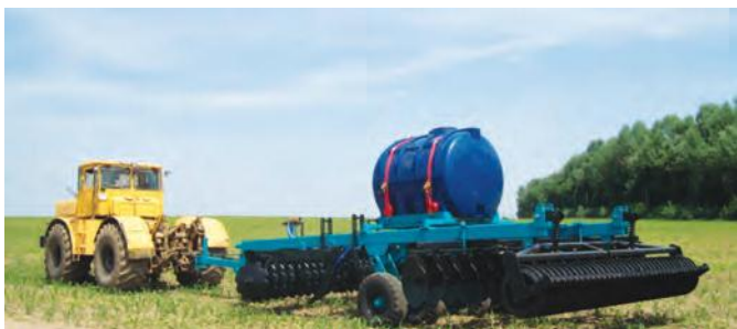
Рис. 1 – Загальний вигляд дискоцизельного агрегата БДВП 4,2-01 з одночасним внесенням рідких добрив
