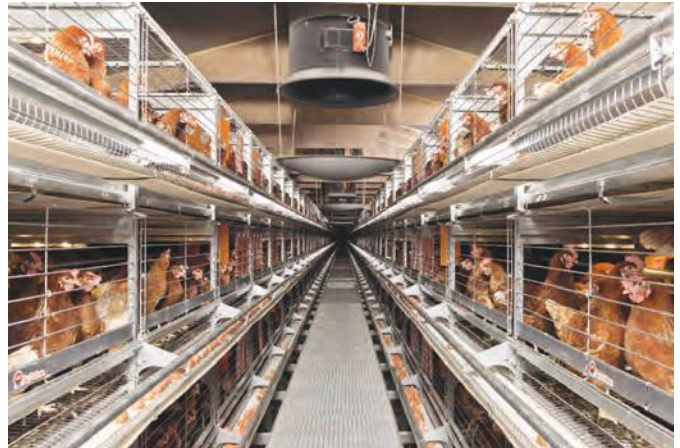
Рис. 34 – Обладнання для утримання курей-несучок EV 2240-EU фірми «Big Dutchman»
