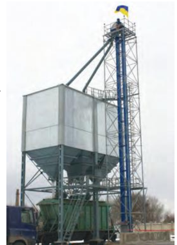
Рис. 15 – Бункер відвантаження зерна у залізничні вагони, виробництва заводу «Сокол»
