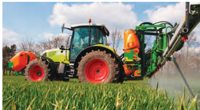
Рис. 9 – Навісний обприскувач UF 1201 фірми Amazone (Німеччина)
