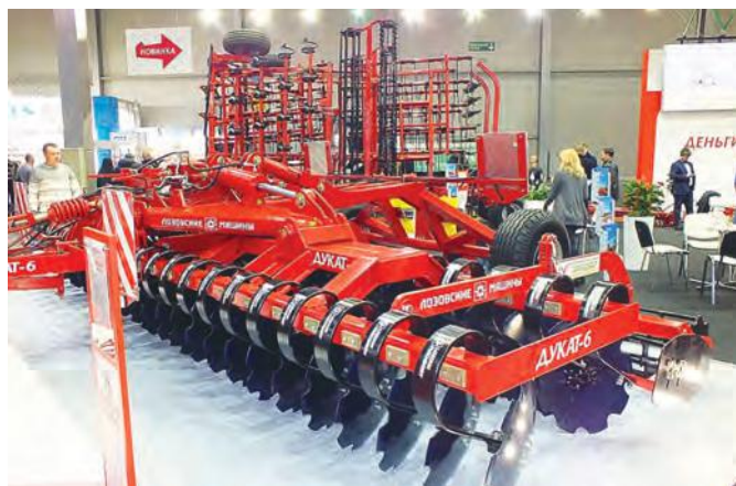
Рис. 4 – Загальний вигляд дискової борони «Дукат-6»
