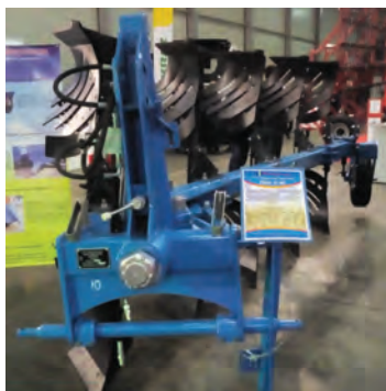
Рис. 2 – Загальний вигляд плуга оборотного ПОН-5П зі смуговими відвалами
