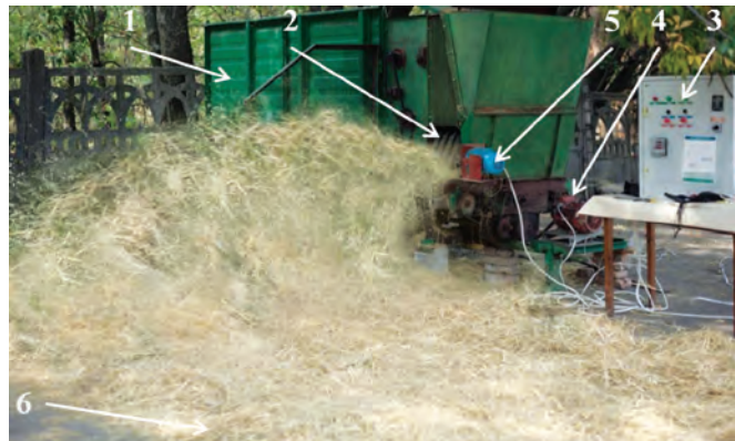
Рис. 2 – Стенд для експериментальних досліджень: 1 – кормороздавач, 2 – експериментальний зразок роторного розкидача із ущільнювальною пластиною, 3 – частотний регулятор Danfoss, 4 – привід кормороздавача, 5 – привід роторного розкидача, 6 – внесена солома
