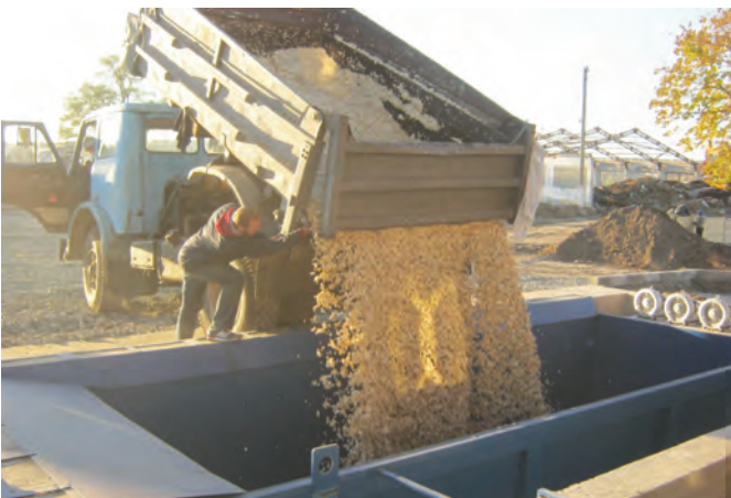
Рис. 3 – Приймальний бункер із функцією аспірації та вивантаження за допомогою насоса для гарбузового насіння V-AB663
