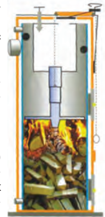
Рис. 4 – Конструкція котла Stropuva
