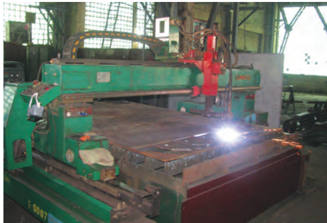
Рис. 9 – Плазмовий розкрій у дії
