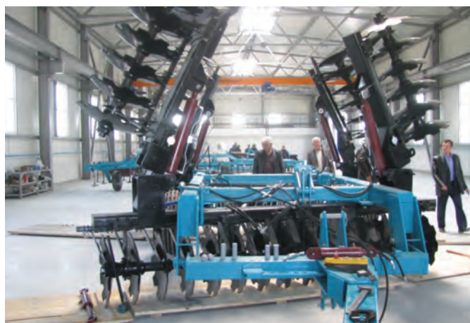
Рис. 10 – Збирання ґрунтообробної техніки в новому збиральному цеху
