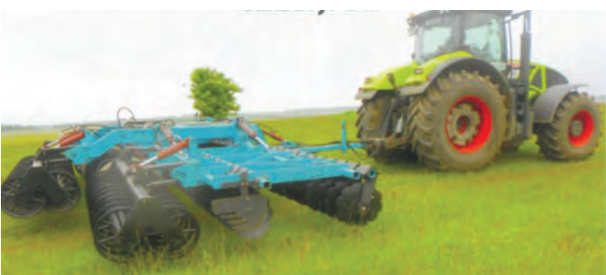
Рис. 14 – Дископак Д-8 причіпний (ширина захвату – 8 м)
