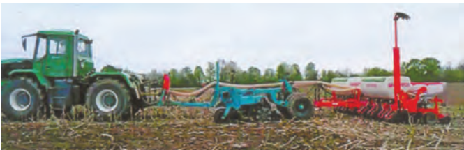
Рис. 12 – Ґрунтообробний агрегат БДЛП-8.0 з посівним модулем сидеральних культур Turbo-jet super-8 ТОВ «Краснянське СП «Агромаш»: а – перед стартом, б – у роботі
