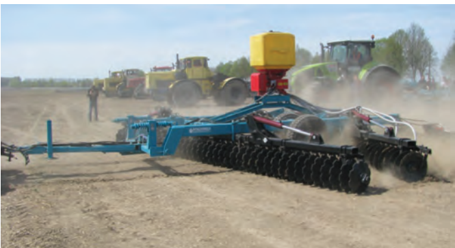
Рис. 12 – Ґрунтообробний агрегат БДЛП-8.0 з посівним модулем сидеральних культур Turbo-jet super-8 ТОВ «Краснянське СП «Агромаш»: а – перед стартом, б – у роботі
