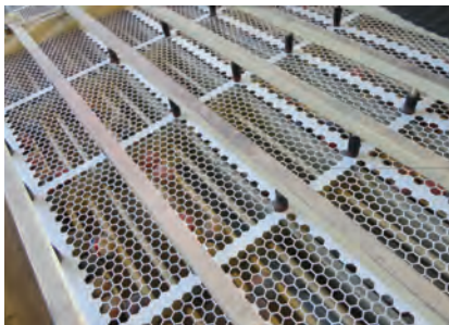
Рис. 2 – Сито Фадєєва з новою робочою поверхнею (вигляд - перший «поверх» вібророзсіву машини «ОКМФ»)
