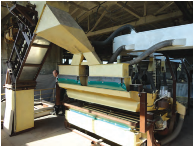
Рис. 1 – Очисно-калібрувальна машина Фадєєва «ОКМФ» (вигляд – з приймальної насіння або зерно частини машини)
