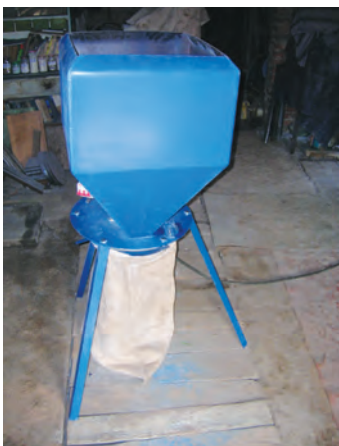
Рис. 1 – Загальний вигляд інноваційної зернодробарки-млина з причепленим збірним мішком
