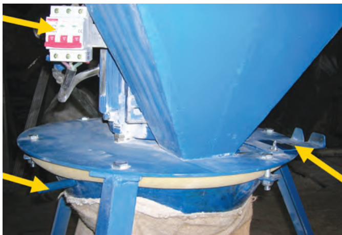
Рис. 2 – Органи управління універсальною зернодробаркою: автомат-вимикач; гвинт регулювання подрібнення; здвоєна заслінка
