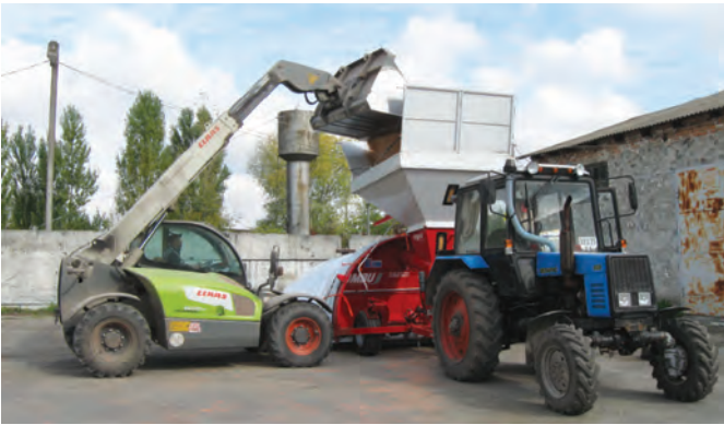
Рис. 4 – Завантаження зерна в зернопакувальну машину універсальним навантажувачем SCORPION-6030 CP (компанія CLAAS)
