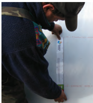
Рис. 5 – Контроль щільності заповненого рукава у вертикальній площині за допомогою спеціальної мірної лінійки
