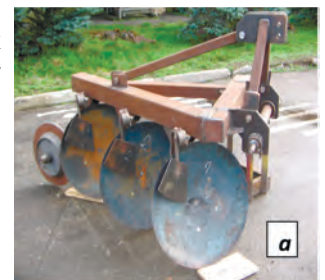
Рис. 3 – Польові дослідження V- подібного знаряддя на підкопуванні цибулевих культур у варіанті агрегування з мотоблоком
