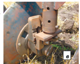
а- базовий варіант з сферичним суцільним диском; б - варіант комплектації вирізними дисками; в - механізм регулювання кутів постановки диска до напрямку руху і вертикалі. Рис. 4 – Загальний вид дискового плуга у двох варіантах комплектації
