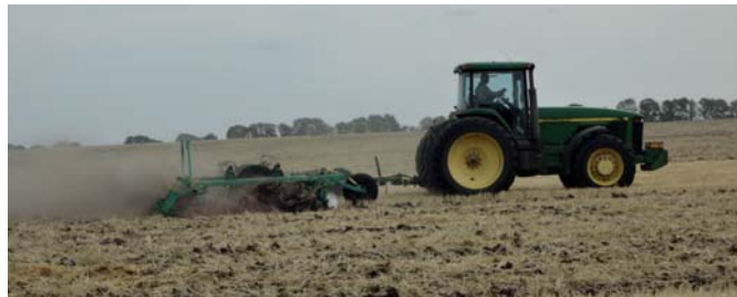
Рис. 10 – Загортання подрібненої та розсіяної соломи в ґрунт дисковою бороною
