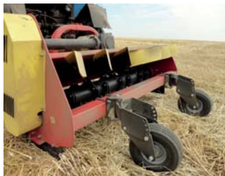
Рис. 2 – Універсальний мульчувач соломи УМС-170 в агрегаті з трактором МТЗ-892 (вигляд мульчувача – ззаду зліва)
