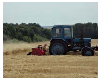
Рис. 7 – Мульчувач УМС-170 в агрегаті з трактором МТЗ-892 під час подрібнення та розсівання соломи озимої пшениці з валка
