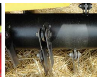
Рис. 5 – Ротор з робочими органами: центральна труба та двобічні ножі
