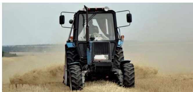
Рис. 8 – Мульчувач УМС-170 забезпечує подрібнення та розсівання соломи пшениці фактично по всій ширині захвату жатки комбайна, з якої сформовано валок
