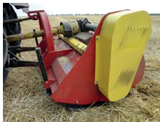
Рис. 3 – Універсальний мульчувач соломи УМС-170 в агрегаті з трактором МТЗ-892 (вигляд мульчувача – збоку зліва)
