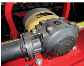
Рис. 4 – Редуктор механічного приводу мульчувача УМС-170
