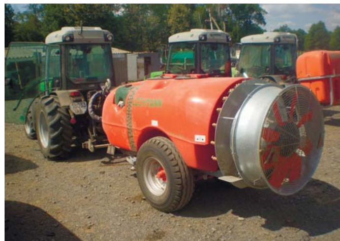
Рис. 4 – Обприскувач вентиляторний RA 15/36 виробництва «Lochmann Plantatec GmbH» (Італія)
