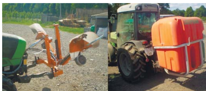
Рис. 2 – Пристосування для внесення гербіцидів HERBIKA OB-2 виробництва «Muller & Sohn Spezialmaschinen GmbH» (Німеччина)
