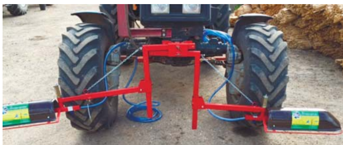
Рис. 1 – Пристосування для внесення гербіцидів Maximarin виробництва ПП «Агрореммаш-Спецтехніка» (м. Кропивницький)
