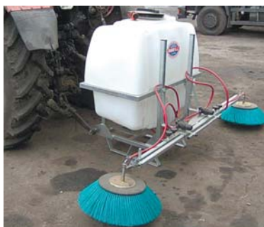
Рис. 3 – Обприскувач для внесення гербіцидів GDE 400 з розміщенням робочої штанги в задній частині агрегата виробництва «Off. Mess. Panari Giancarlo & C.» s.n.c. (Італія)
