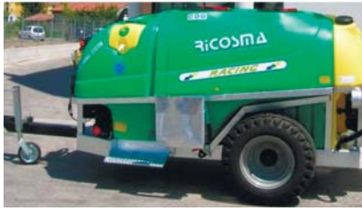
Рис. 5 – Обприскувач вентиляторний RACING 3000L виробництва «Ricosma S.p.A» (Італія)
