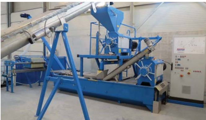
Рис. 2 – Загальний вигляд модульного пресцеку CP2
