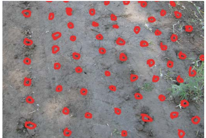
Рис. 6 – Реальний вигляд слідів, сформованих зубчастими дисками агрегата на ущільнений ґрунт
