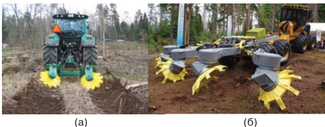
Рис. 6 - Активні дискові (а) та дисково-зубові фрезерні (б) культиватори
