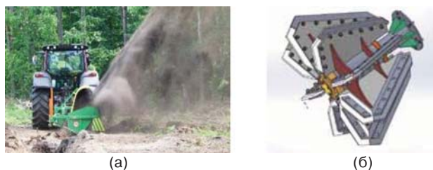
Рис. 8 – Плуг-фреза: а) – під час роботи, б) – ґрунтообробний пристрій
