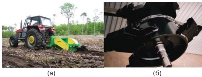
Рис. 7 – Лісова ґрунтообробна фреза (а) та її робочий орган (б)
