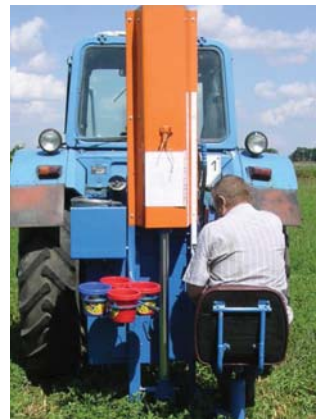
Рис. 17 – Загальний вигляд розробленого навесного пробовідбірника під час роботи (вигляд ззаду трактора)
