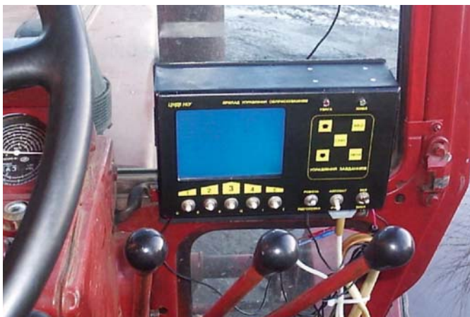
Рис. 18 – Загальний вигляд бортового комплексу управління під час відбору проб ґрунту
