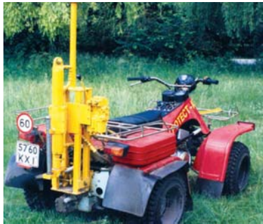
Рис. 14 – Макетний зразок пробовідбирача на базі 4-колісного мотоцикла ММТ-350 виробництва УкрНДІПВТ ім. Л.Погорілого
