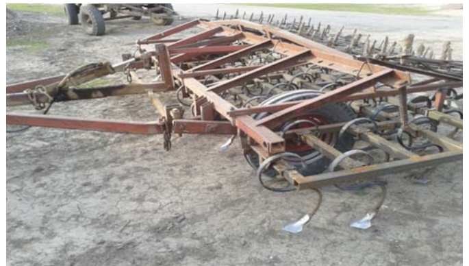
Рис. 3 – Секція культиватора, обладнана дослідними зразками лап
