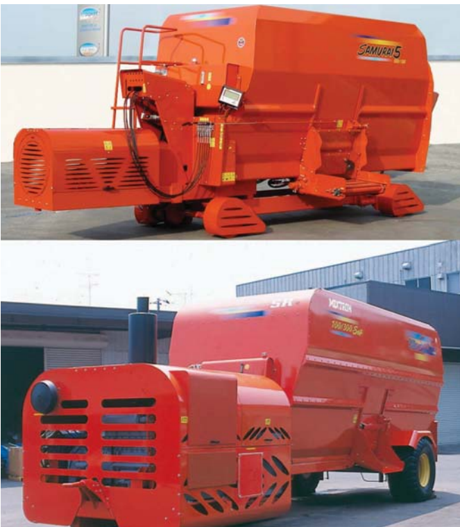
Рис. 24 – Стаціонарні фермські комбайни з горизонтальними шнеками з приводом від електродвигуна і двигуна внутрішнього згорання
