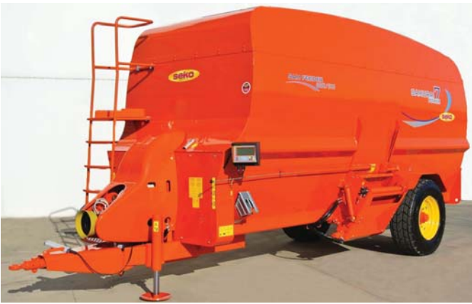
Рис. 23 – Фермський комбайн Samurai 7 з двома горизонтальними шнеками
