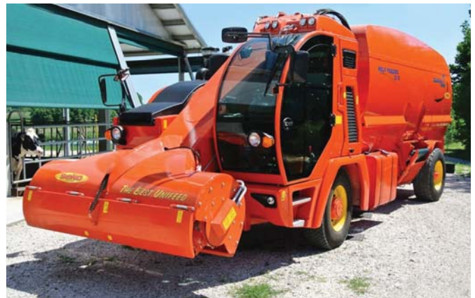
Рис. 22 – Фермський комбайн з горизонтальними робочими органами Samurai 7
