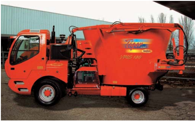
Рис. 15 – Фермський комбайн, обладнаний одним конічним вертикальним шнеком, Tiger Self
