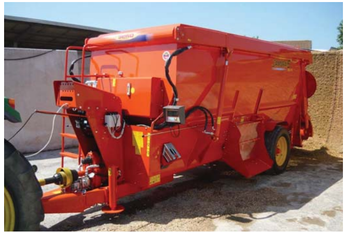
Рис. 21 – Причіпний фермський комбайн Samurai 5 з двома горизонтальними шнеками
