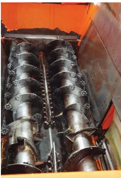
Рис. 17 – Горизонтальні шнекові робочі органи фермського комбайна моделі Samurai 7 Self фірми «Seko» (Італія)
