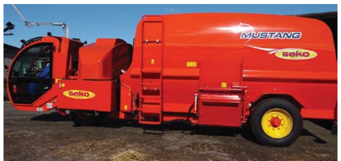
Рис. 26 – Фермський комбайн з горизонтальними робочими органами Mustang фірми «Seko» (Італія)
