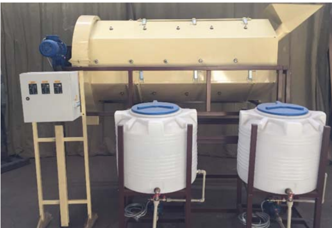
Рис. 9 – Протруювач насіння Фадеєва (ПСФ)
