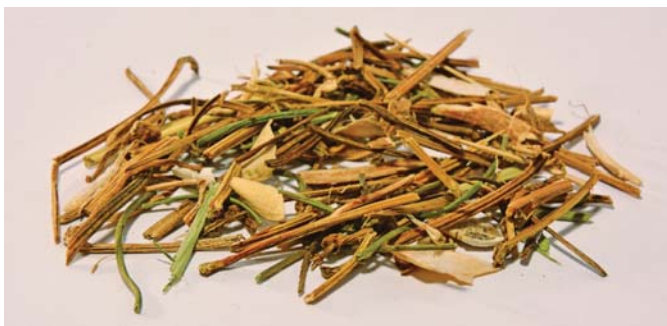
Рис. 4 – Крупне сміття, яке зійшло зі скальператора
