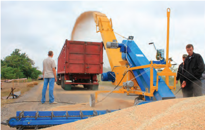
Рис. 28 – Метальник зерна МЗС-120 «Давид»
