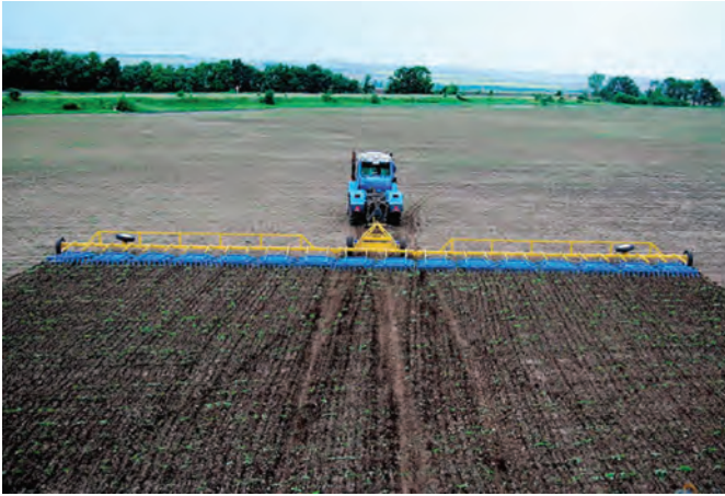
Рис. 27 – Борони з пружинними зубами моделі БЗП виробництва ТОВ «ОЗСМ «Агротех»
