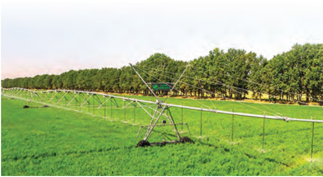
Рис. 23 – Зрошувальна установка фронтального типу «Variant Agro Build»
