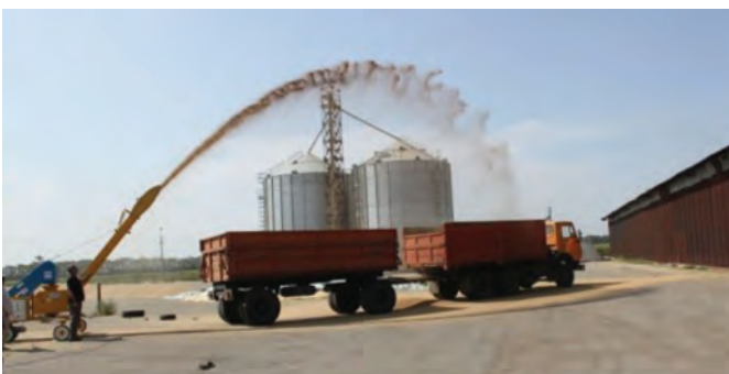
Рис. 29 – Метальник зерна МЗС-170 «Голіаф»
