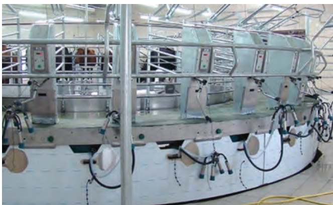
Рис. 26 – Доїльні установки «Карусель» фірми VAB
