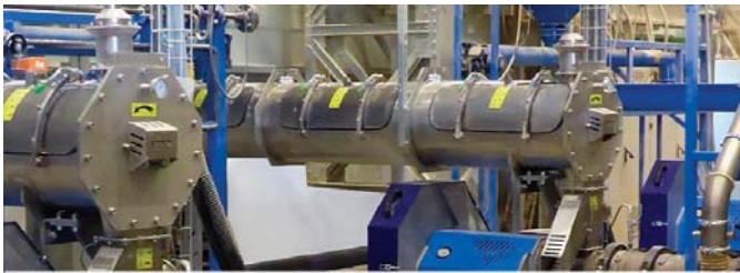
Рис. 2 – Обладнання фірми «Farmet» для сухої та мокрої екструзії
