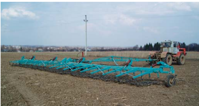
Рис. 1 – Зчіпка гідрофікована ЗГ-18 з набором зубових борін виробництва ТОВ «Краснянське СП «Агромаш»
