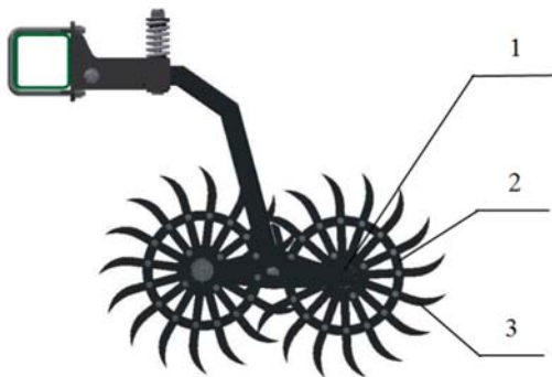
Рис. 16 – Загальний вигляд робочого органу борони ротаційної Green Star: 1) – маточина; 2) – кільце жорсткості; 3) – голка
