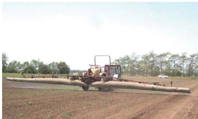
Рис. 3 – Причіпний обприскувач «Hardi», обладнаний повітряними рукавами примусового осадження крапель
