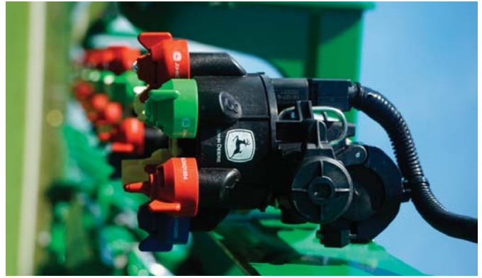
Рис. 10 – Пневматичні відсічні пристрої «John Deere» (США) з шістьма розпилювачами
