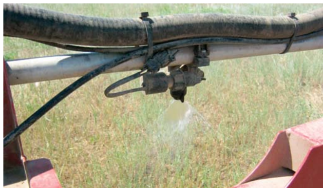
Рис. 6 – Розпилювальний пристрій обприскувача «Case Patriot», обладнаний електромагнітним клапаном системи керування тиском «Aim Command»
