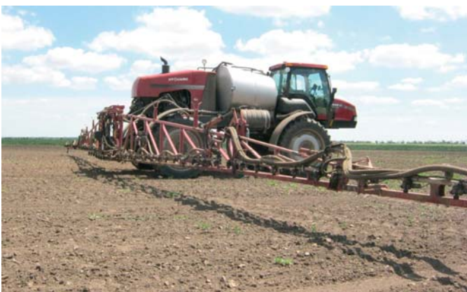
Рис. 5 – Самохідний обприскувач «Case Patriot» із системою керування тиском «Aim Command»
