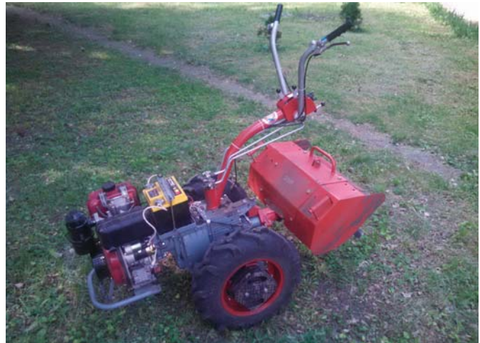
Рис. 1 – Загальний вигляд мотоблока "Мотор Січ МБ-6ДЕ" з культиватором
