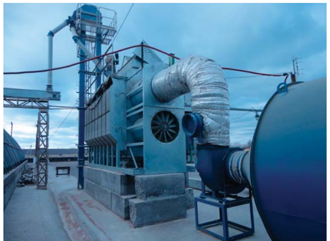
Рис. 2 – Установка зерносушильна СГТ-1082: теплообмінник (на фото – справа) та установка модульна секційна (на фото – по центру)
