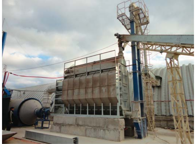
Рис. 1 – Установка зерносушильна горизонтальна СГТ-1082, секційна, модульного типу (вигляд – збоку)
