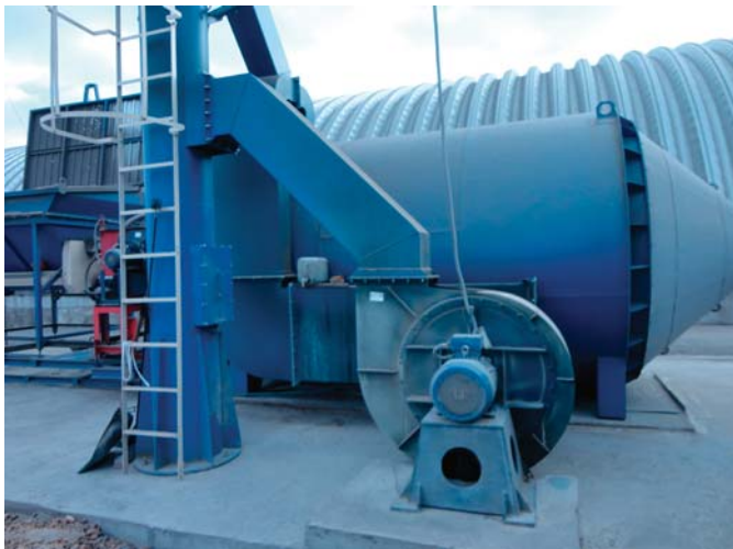
Рис. 7 – Теплообмінник і система видалення диму (вигляд обох систем – збоку)
