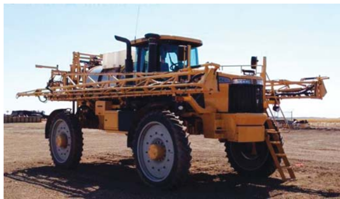
Рис. 2 – Самохідний обприскувач Rogator
