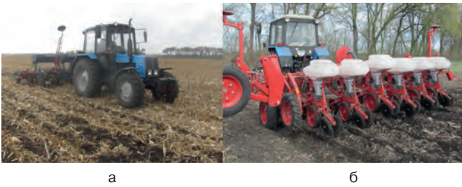
Рис. 1 – Комплекс машин для вирощування культур за смугового обробітку ґрунту: а – агрегат для нарізання смуг с одночасним внесенням мінеральних добрив СТА-4; б – просапна сівалка ВЕГА-8 з висівними секціями, дообладнаними блоком зірочок для роботи в умовах високого вмісту рослинних решток
