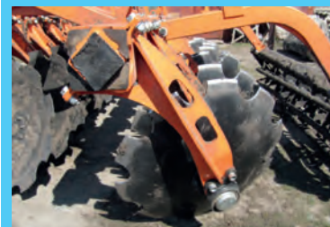
Демпферне кріплення системи підвіски стійки з дисковим робочим органом до рами
