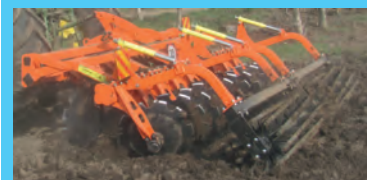
Загальний вигляд робочих органів борони (диски, коток) та гвинтових механізмів регулювання глибини обробітку
