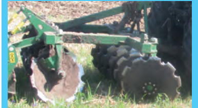
Рама з жорстко закріпленими дисками, навіска та кронштейн для агрегування з трактором
