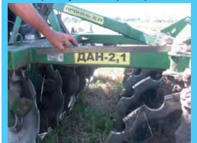
Пристрій для очищення дисків від ґрунту та рослинних решток
